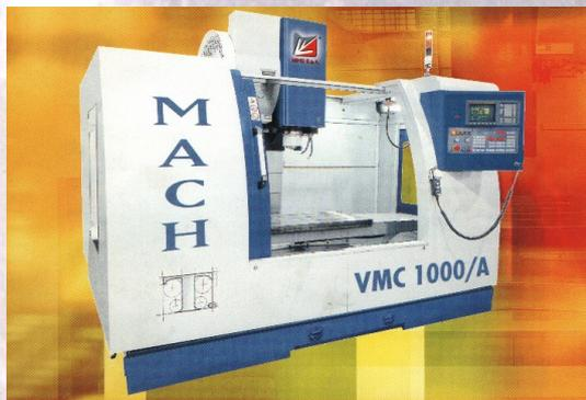
finiti, per garantire la stabilità e la precisione nel tempo, il centro lavora su guide quadre, temperate, rettificata e surdimensionate con controguide in *Turcite B*, è dotato di un gruppo testa mandrino e tavola di grandi dimensioni (mm.1200x600), con magazzino utensili provvisto di braccio
